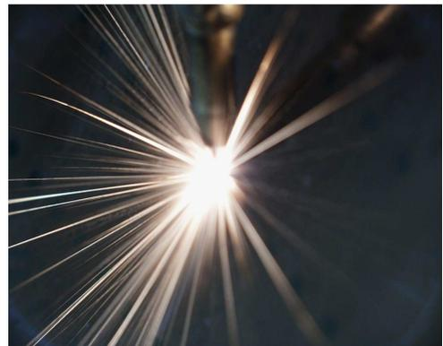
Kühlbohrungen in Turbinenschaufeln werden ohne Beeinflussung des Materials eingebracht. Weitere Anwendungsbereiche sind das Einbringen von Entlüftungsbohrungen in Formen für Reifenprofile und das Bohren von Startlöchern für das Drahterodieren.
